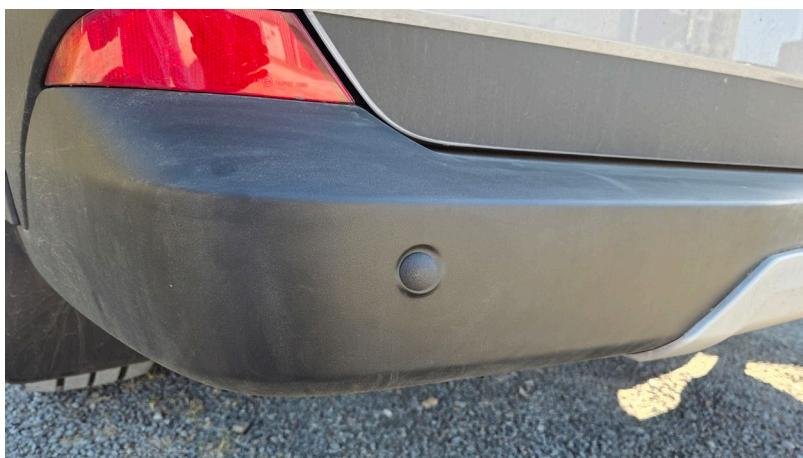
Plastikstopfen in die Löcher der Parksensoren in der Stoßstange einsetzen.
