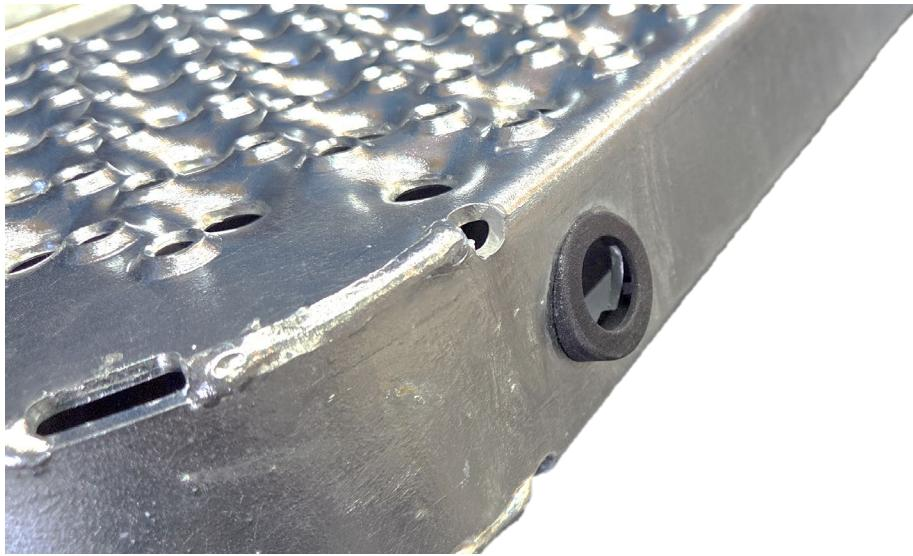
Entfernen Sie die Abdeckkappen in der Trittstufe und setzen Sie die Halterung für die Parksensoren wie oben abgebildet ein, achten Sie auf die richtige Ausrichtung.
