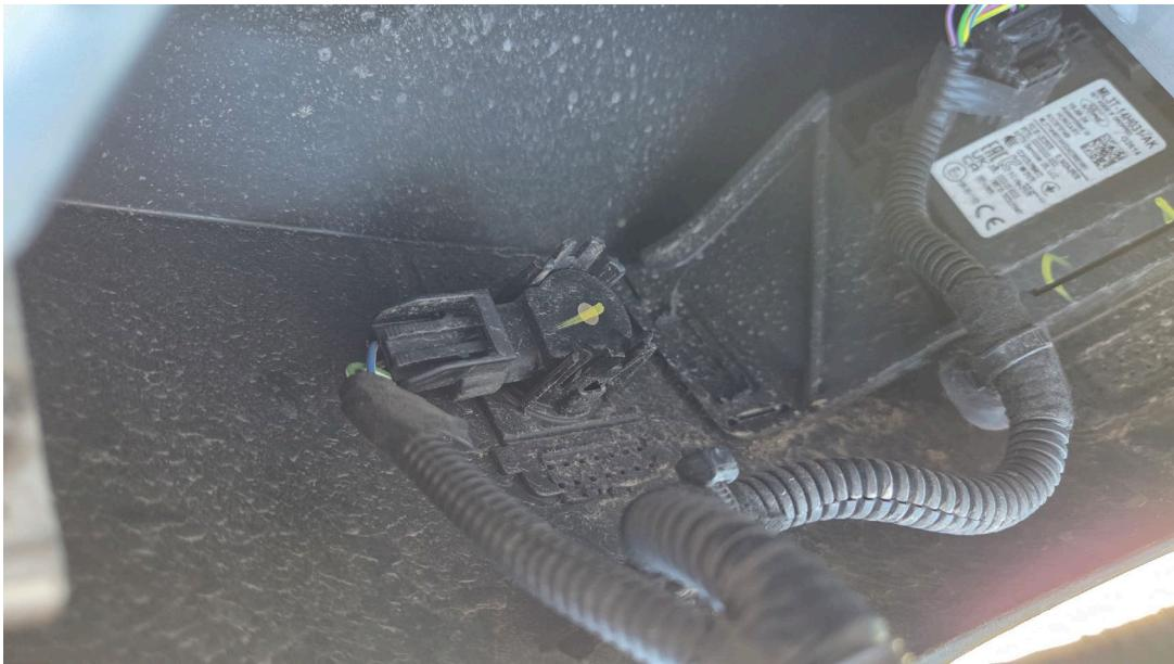
Entfernen Sie die original Parksensoren aus der Stoßstange des Fahrzeugs und entfernen Sie das Kabel vom Parksensor.
