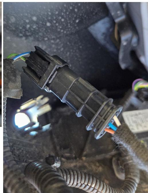
Verbinden Sie das Adapterkabel mit dem vorhandenen Stecker am Fahrzeug. Stellen Sie sicher, dass die Steckerverriegelung vollständig eingerastet ist.
