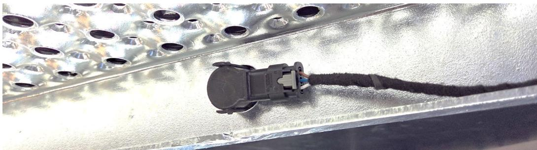
Adapterkabel an den Parksensor anschließen und evtl. Kabel mit Kabelbindern befestigen, um Kabelschlaufen zu vermeiden.
